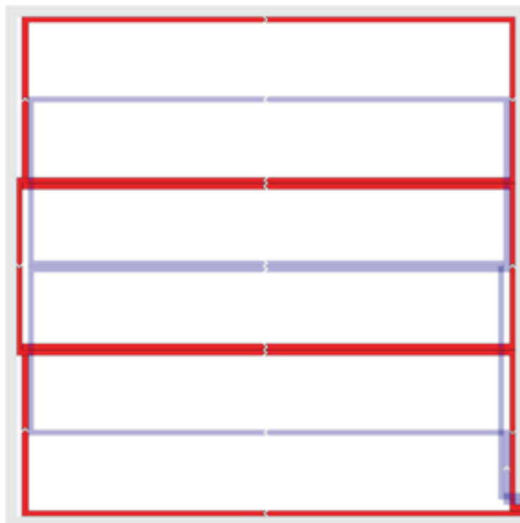
Rys. 2. Przykładowy schemat prowadzenie przewodów każdej z pętli (master – czerwony, slave – niebieski)
